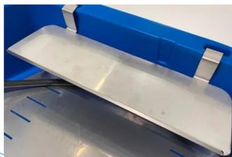
Ablagefläche für gereinigte Bauteile oder Reinigungsutensilien
